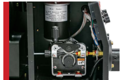
sistema de tracción con 2 poleas
